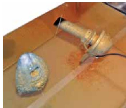
Na brončani i inoks usis mora smo spojili napajanje sunčanog kolektora. Napon solarnog panela pri dnevnom svjetlu (bez sunca) je bio 8 V i već je nakon 5 dana vidljivo je djelovanje korozije na svim uronjenim dijelovima
