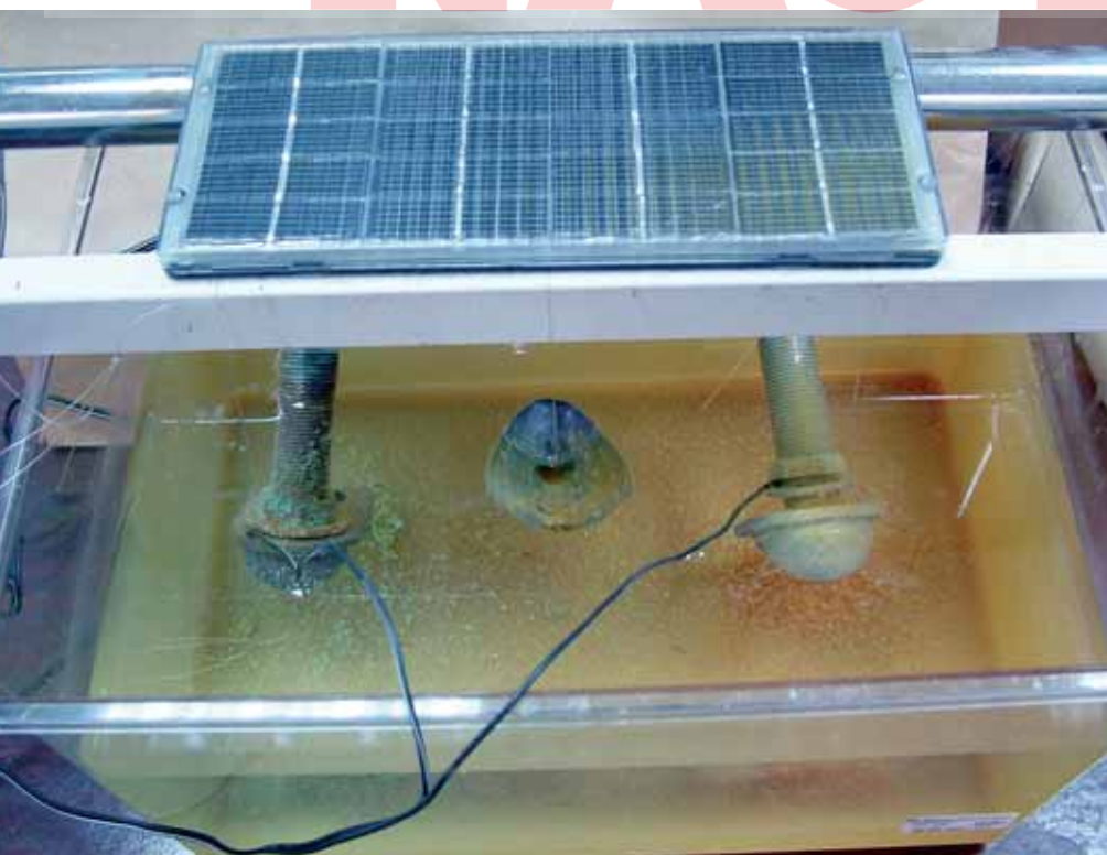
Na brončani i inoks usis mora smo spojili napajanje sunčanog kolektora. Napon solarnog panela pri dnevnom svjetlu (bez sunca) je bio 8 V i već je nakon 5 dana vidljivo je djelovanje korozije na svim uronjenim dijelovima
