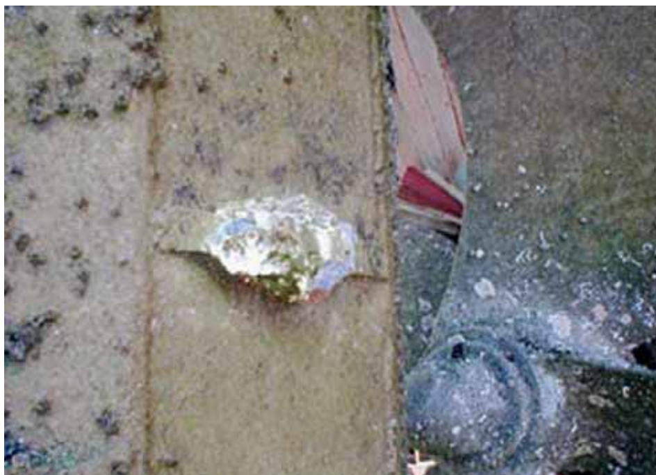
Ovako izgleda potpuno "istrošena" anoda
