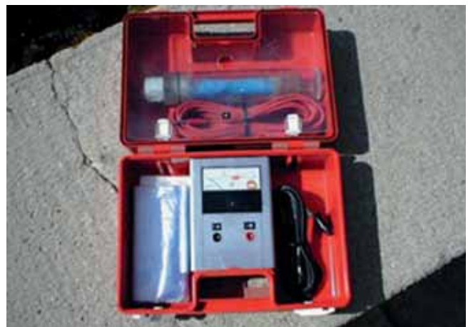
Sa aparatom za mjerenje elektropotencijala možemo jednostavno izmjeriti da li protektori "rade" ili ne na plovilu u moru
